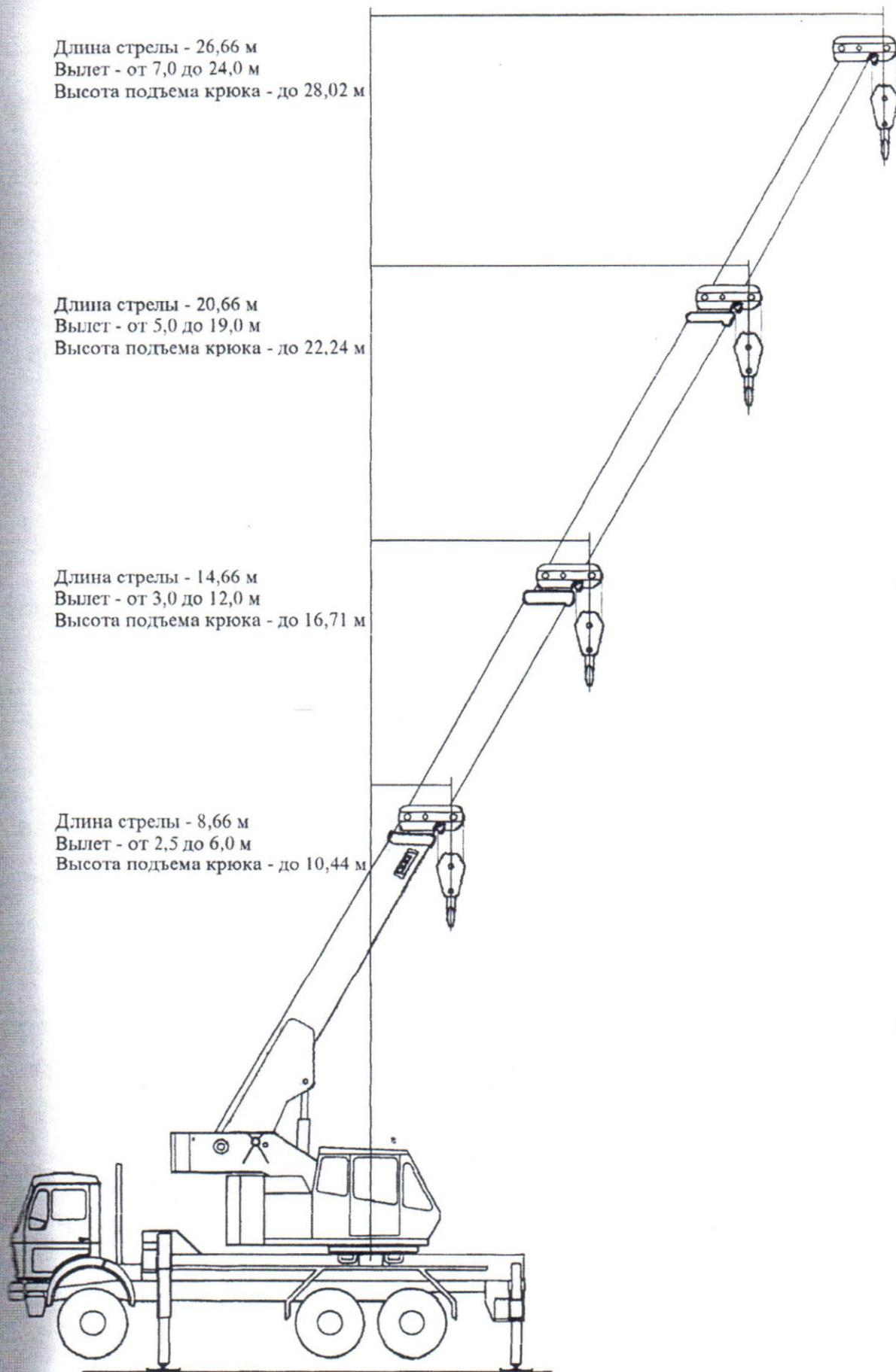
Рисунок 1.1. Общий вид крана GT-35/27 в рабочем положении.
