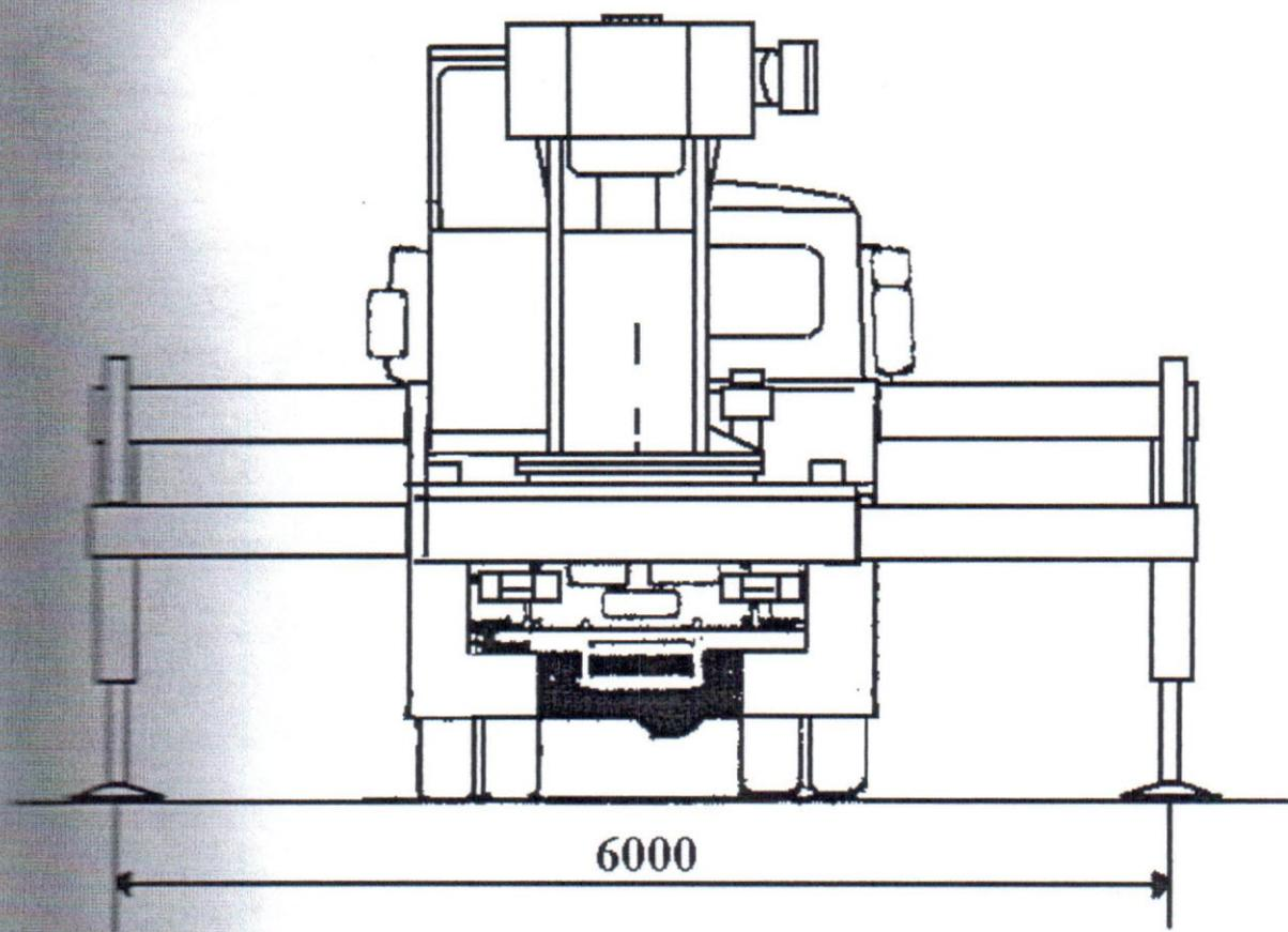
Рисунок 1.4. Общий вид крана GT-35/27 на выносных опорах (вид сзади).
